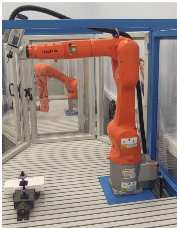
Рисунок 1 – Роботизированная ячейка, предназначенная для выполнения фрезеровки
